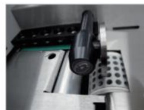
Système d'alimentation à succion par le bas (pas de rupture de flux).
