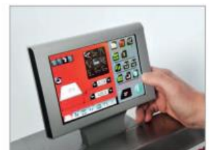
Écran de commande tactile pour effectuer tous les réglages.
