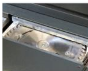
Fraisage des documents pour une meilleure pénétration de la colle.
