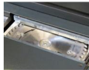
Fraisage des documents pour une meilleure pénétration de la colle.
